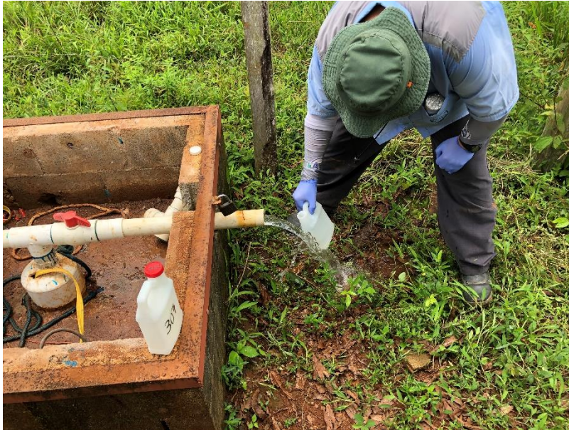
Fotografía 7: Recolección de la muestra de agua del pozo de la ADI de Llano Verde de Pocosol. (Coordenadas 319,782 Norte y 493,722 Este, proyección Lambert Costa Rica Norte)
