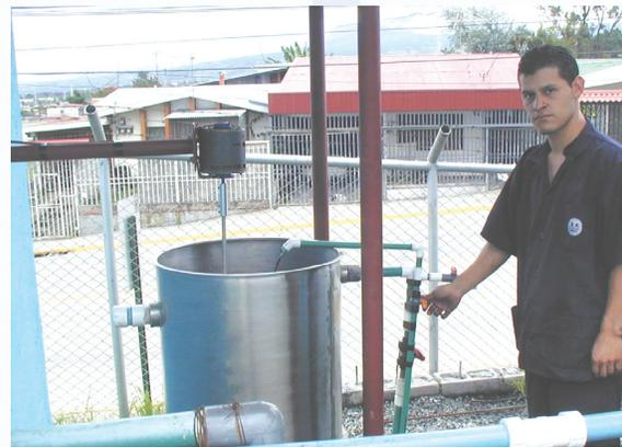
FIGURA 3 Reactor utilizado en la evaluación sistema de carbón activado
