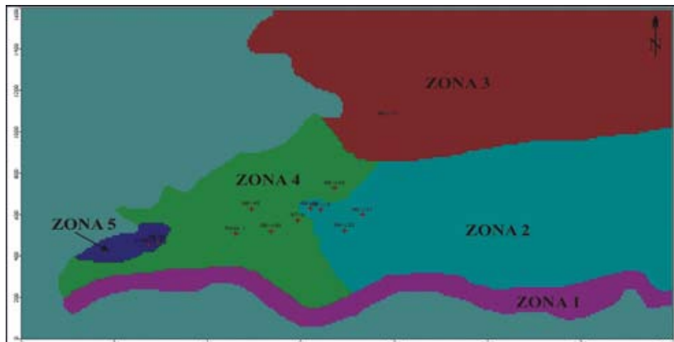
Figura 19. Zonas de conductividades hidráulicas para los aluviones del acuífero La Bomba.
