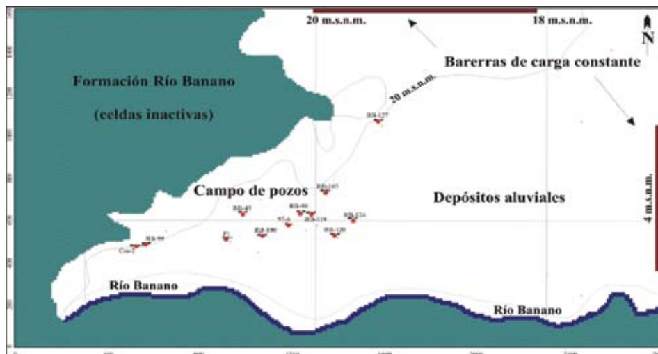
Figura 18. Esquema del modelo numérico en Visual Modflow que muestra las celdas inactivas, el río Banano, el campo de pozos y las dos barreras de carga constante asignadas.
